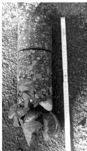
SCHÉMA č.6: Skladba vrstev vozovky na předmostí v místě sondy SK3
